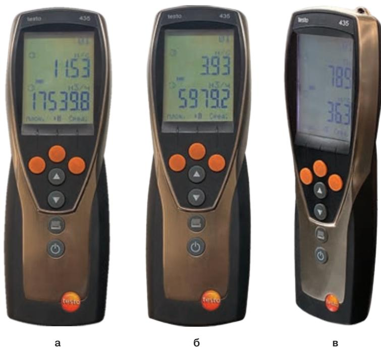
Рис. 2. Результат измерений параметров в межквартирном коридоре при проведении пусконаладочных испытаний:
