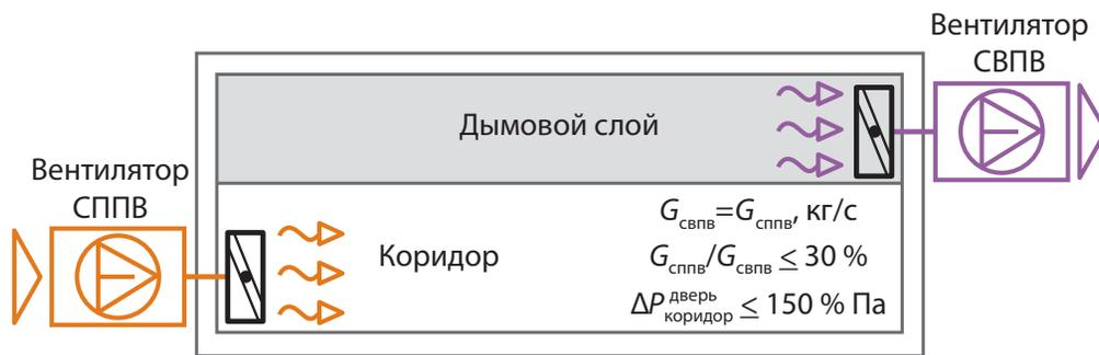
Рис. 1. Схема работы механической противодымной вентиляции в коридоре
