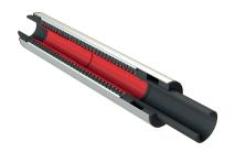
нержавеющей стали. Данная конструкция исключает возникновение разности потенциалов благодаря однородности материалов, что предотвращает сквозную коррозию в компенсаторе. Также конструкция новой модели внутреннего экрана не допускает возможности повреждения гофр при соприкосновении с внутренней частью сильфона, что является важной особенностью.
