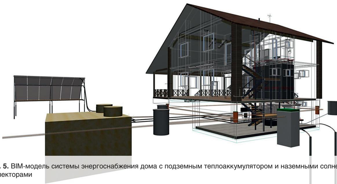
**Рис. 5.** BIM-модель системы энергоснабжения дома с подземным теплоаккумулятором и наземными солнечными коллекторами
