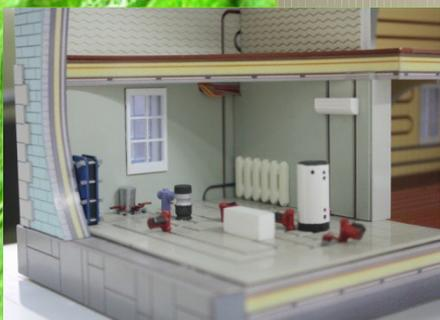
2) **Отопление** жилых зданий и теплиц, а также **ГВС** осуществляется за счет совместной работы солнечных водогрейных коллекторов, тепловых насосов и аккумулирующих тепловых емкостях. Для увеличения КПД насосов рассматриваются различные варианты теплосъемных поверхностей.
