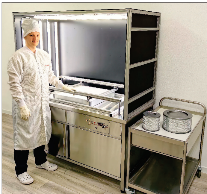
■ Рис. 4. Испытания HEPA-фильтров на утечку
