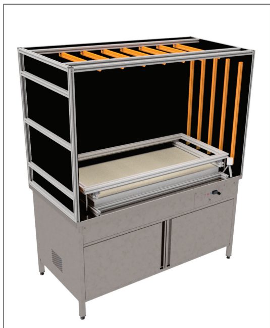
■ Рис. 3. 3D-модель IC Oil Test Aseptica ISO 1822
