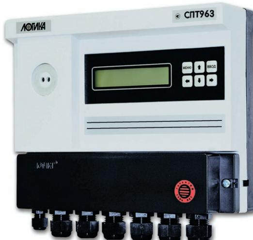
Регулирование режимов теплоснабжения и ГВС осуществляется с применением адаптеров АДР260. К вычислителю по интерфейсу RS-485 можно подключить до четырех адаптеров АДР260, каждый из которых по командам от СПТ963 непосредственно управляет исполнительным механизмом одного контура регулирования и включением/выключением насосов данного контура.
