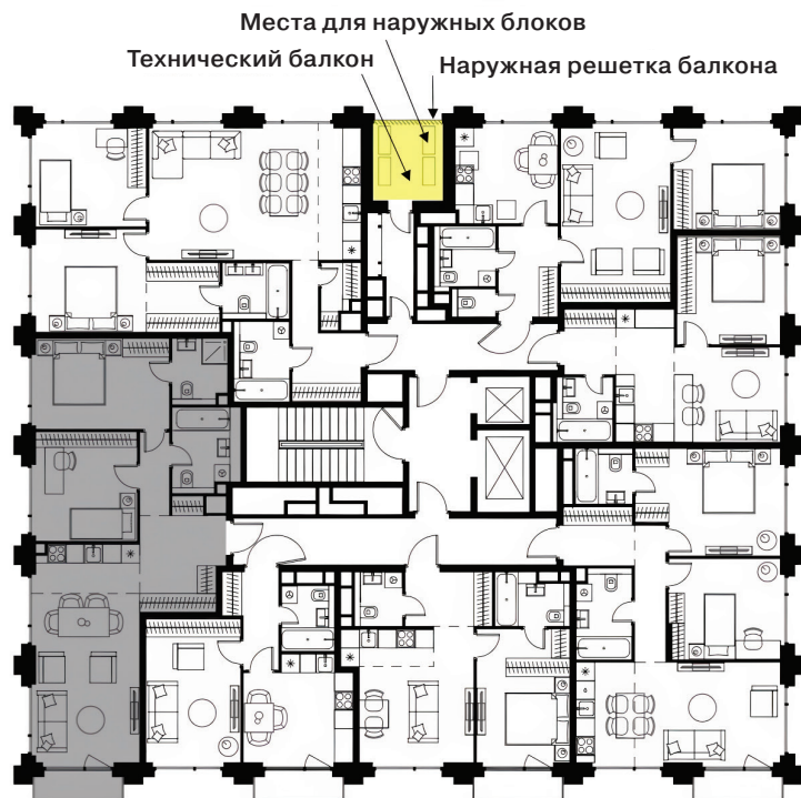
Рис. 3. Пример плана с техническим балконом, закрытым декоративной решеткой
