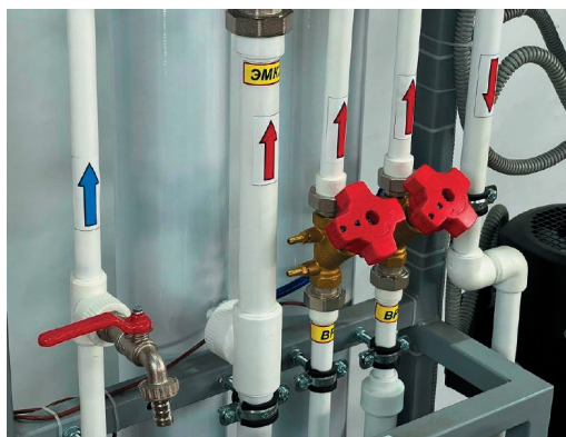
Установка осмоса малой производительности (0,50 м³/ч): подписи и обозначения гарантируют правильное подключение
