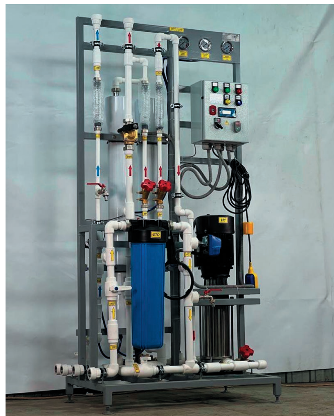
Установка осмоса малой производительности (0,50 м³/ч): подписи и обозначения гарантируют правильное подключение
