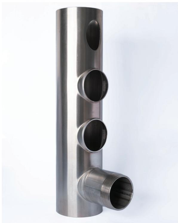
■ Рис. 2. Этапы изготовления коллектора с применением вытяжки отверстий
