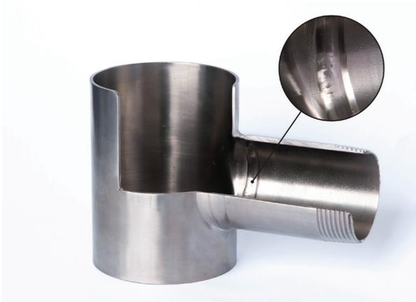
Рис. 3. Соединение труб при использовании вытяжки отверстий и автоматической кольцевой сварки (вид изнутри)
