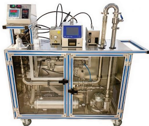
■ Рис. 2. Полуавтоматический испытательный стенд ИС-ФМ для проверки плоских фильтрующих материалов
