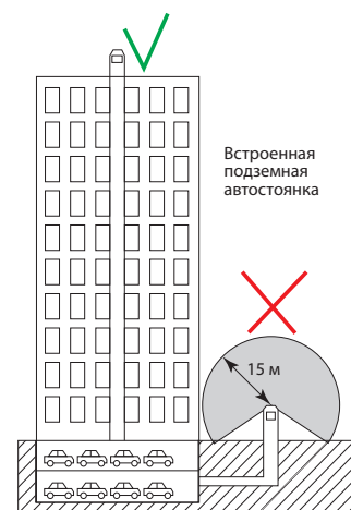
■ Рис. 3. Выброс из автостоянки, расположенной строго под зданием, необходимо выводить на кровлю здания (п. 7.6.10 СП 60.13330.2020; п. 6 СанПиН 2.2.1/2.1.1.1200-03)
