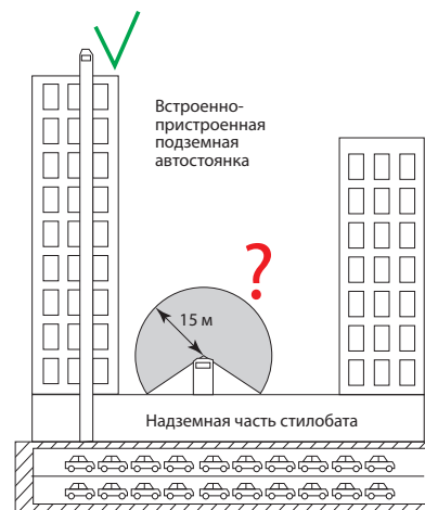
■ Рис. 3. Выброс из автостоянки, расположенной строго под зданием, необходимо выводить на кровлю здания (п. 7.6.10 СП 60.13330.2020; п. 6 СанПиН 2.2.1/2.1.1.1200-03)
