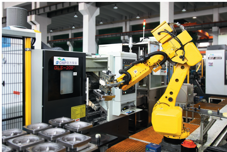
Рис. 7. Процесс сборки насоса роботизированной техникой
