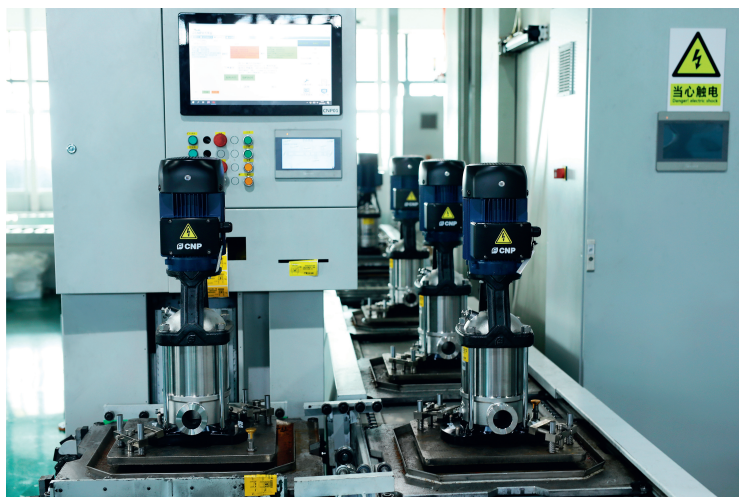
Рис. 9. Процесс транспортировки насосов со сборочной линии на линию конвейерной упаковки
