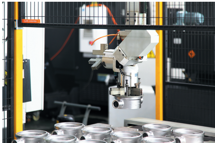
Рис. 8. Процесс сборки насоса роботизированной техникой
