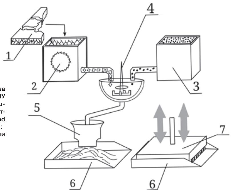
■ Рис. 1. Ориентировочная схема производства клеевых плит на основе отходов ППУ (на основе исследований Промышленного союза производителей жесткого ППУ Германии – Industrieverband Polyurethan-Hartschaum e. V., IVPU [8]):
