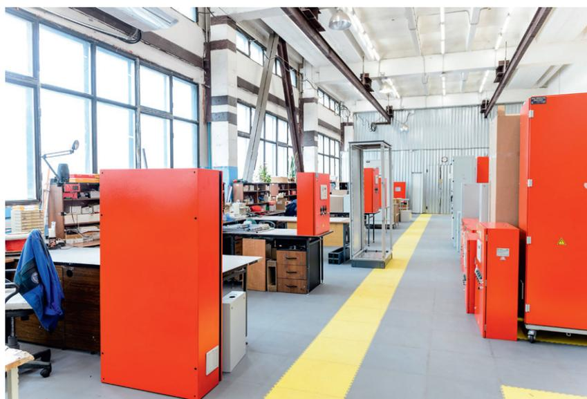
Завершающий этап выпуска как адресных извещателей и устройств, так и других приборов и панелей «Спрут-2» – индивидуальная проверка каждого изделия на участке приемо-сдаточных испытаний, где конечная проверка на работоспособность также проводится с применением специализированного программного обеспечения.
