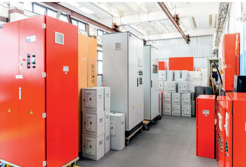
одного шкафа, проведение слесарных работ корпуса, сборка и электроустановка шкафа, оклейка всех внутренних элементов и подготовка эксплуатационной документации, программирование параметров (для отдельных типов шкафов), индивидуальная проверка готового изделия на участке ПСИ, где проверяется не только работоспособность изделия, но правильность оклейки и оформления документации.
