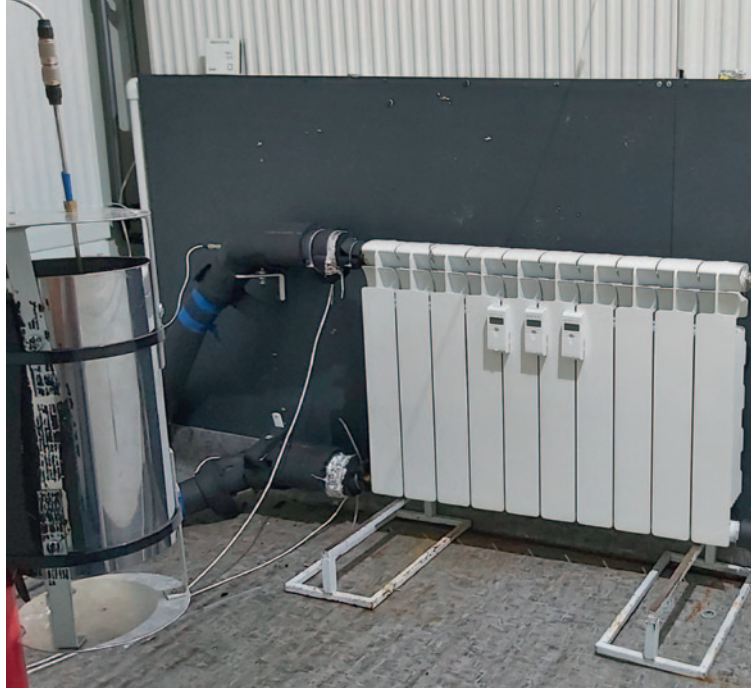
■ Рис. 2. Стенд для проведения испытаний по измерению величины C : климатическая камера Danfoss на предприятии в Московской области
