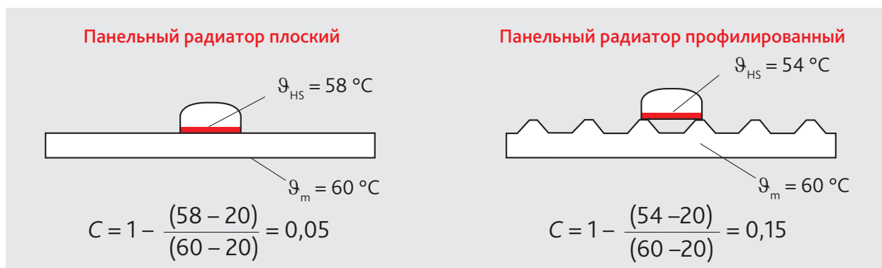
■ Рис. 1. Зависимость величины C от степени контакта задней стенки распределителя с поверхностью радиатора
