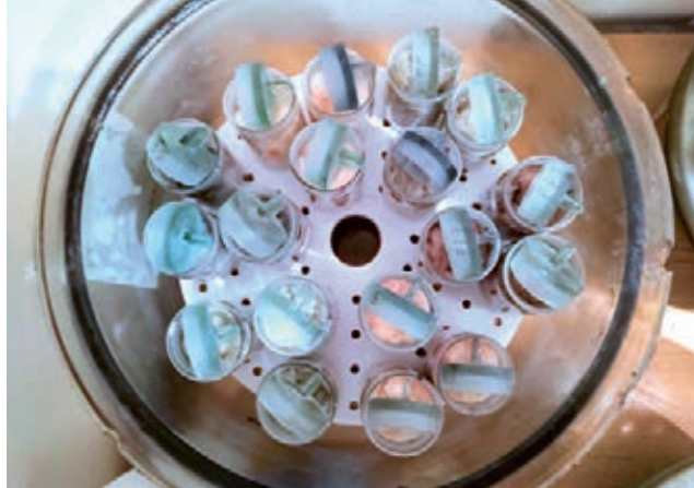
Рис. 1. Процесс экспериментального определения сорбционной влажности эксикаторным методом и бюксы с образцами минераловатных изделий в эксикаторе
