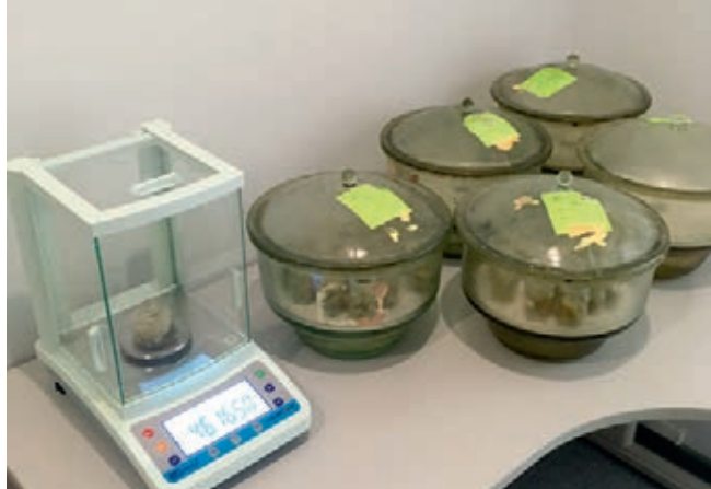
Рис. 1. Процесс экспериментального определения сорбционной влажности эксикаторным методом и бюксы с образцами минераловатных изделий в эксикаторе
