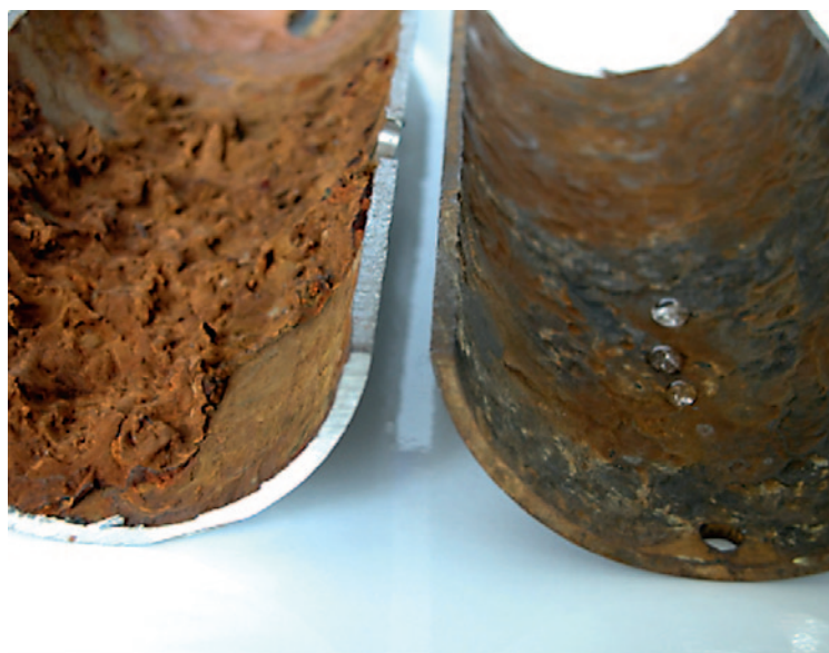
Рис. 1. Трубопровод до и после применения ПАВ-технологии
