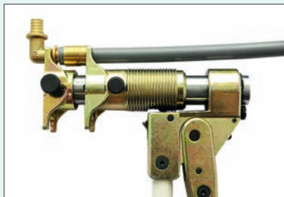
5. Запрессовать гильзу на фитинг с помощью ручного пресса с соответствующими диаметру трубы насадками.
