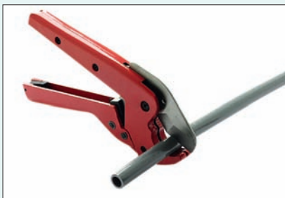
1. Отрезать трубу специальными ножницами строго под прямым углом.
