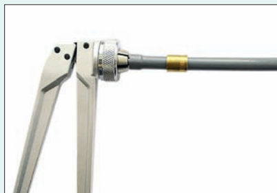
3. Вставить расширительную головку в трубу требуемого диаметра до упора. Равномерно свести рукоятки расширителя.
