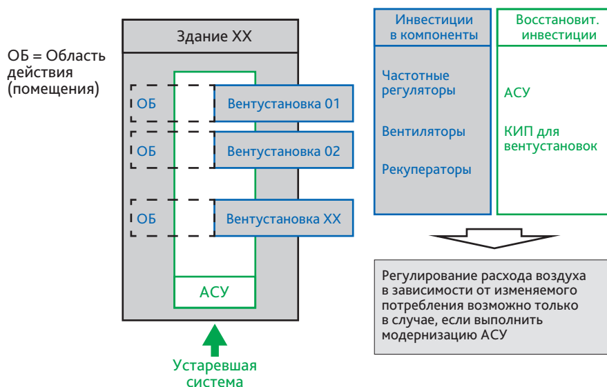
■ Рис. 4. Компонентная модернизация вентиляционных установок. Проблема с устаревшей АСУ
